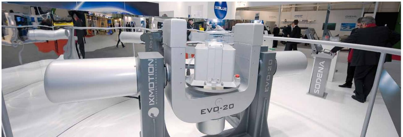
**Simulateur de mouvements deux axes :** EVO-20
