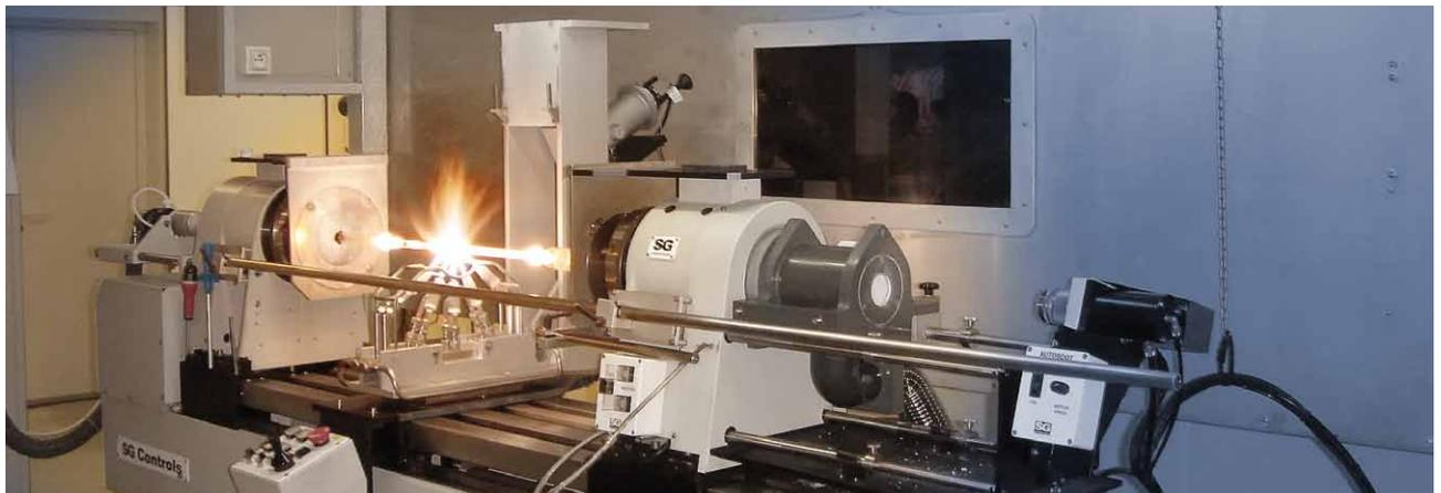
**Banc de fabrication de préformes de fibre optique**
